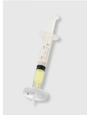
Schrauben Sie die gefüllte Spritze auf den Filter
